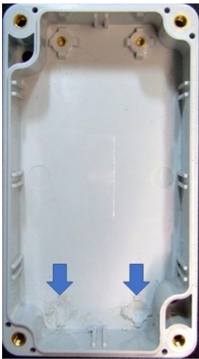
Zwei Schraubhalter unten im Gehäuse mit 10er-Bohrer o.ä. entfernen
