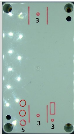
Die Bohrlöcher angezeichnen
