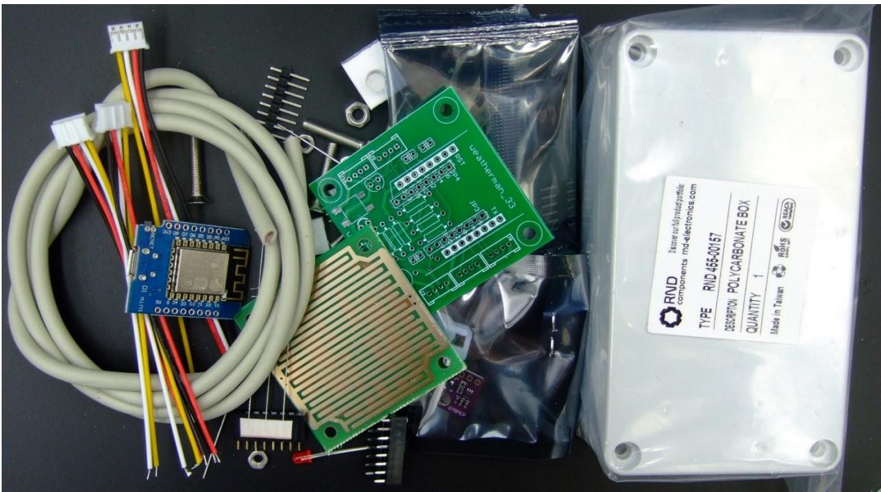
Ein möglichst temperaturgeregelter Lötcolben (ca. 380°C) sollte für die Lötarbeiten vorhanden sein. Jetzt kann die Platine bestückt werden. Dazu erst die kleinen und flachen Teile verlöten und dann die größeren Teile bzw. Module.
