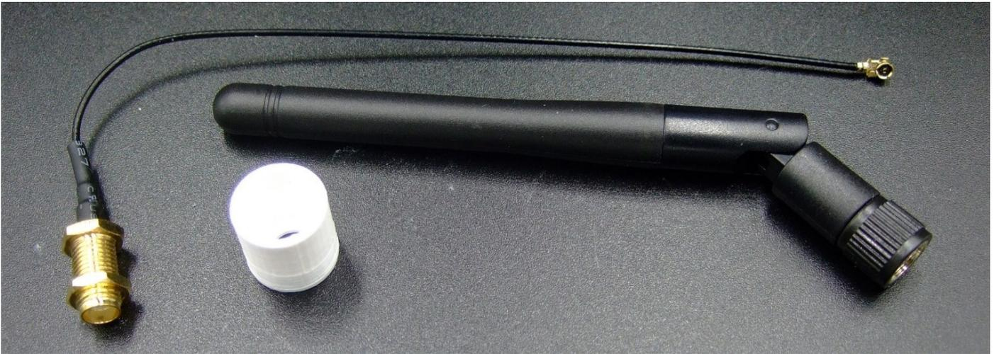
Dieser Pigtail-Anschluß wird aber hier nicht verwendet und kann entsprechend dem folgenden Bild abgeschnitten werden. Das dünne Koaxkabel muß dann abisoliert und verzinkt werden werden:
