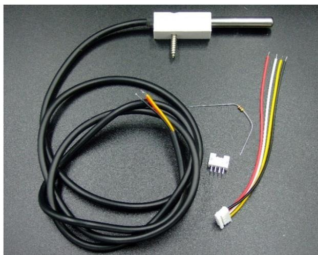
Über ein Kabel wird der Sensor mit dem WEATHERMAN verbunden. Als Kabellänge habe ich bis 5m ausprobiert, möglicherweise kann das Kabel aber auch länger sein (Ausprobieren!). In meiner Wetterstation habe ich den externen Sensor im Schatten unterhalb des Controllergehäuses platziert. Das ist je nach Sonnenstand nicht ganz optimal, aber für mich akzeptabel.
