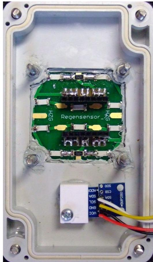
Der Helligkeitssensor mit dem angelöteten Luftdrucksensor wird wie auf dem Bild ebenfalls mit Sikkaflex sorgfältig eingeklebt. Die sichtbare kurze Blechschraube dient dazu, daß der Lichtsensor genau positioniert wird und nicht herausgezogen werden kann.
