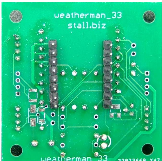
Beim WeMos-Modul werden die beiden Stiftbuchsen mit den langen Beinchen entsprechend den folgenden Bildern eingelötet:
