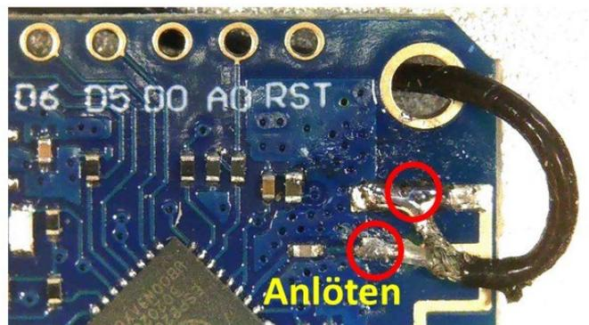
Die Antenne allein gibt noch keine Gewähr für eine gute WLAN-Verbindung zum Router. Viel wichtiger ist die richtige Ausrichtung des Antennenstummels, was man durch Ausprobieren einstellen muß. Hilfreich ist dabei der sog. rssi-Wert auf der Expertenseite:
