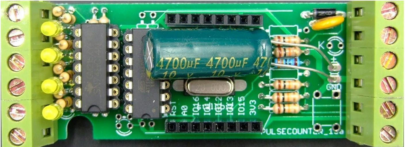
Danach mit dem Elektronik-Seitenschneider alle Lötstellen einkürzen ( bis auf die Schraubklemmen!) und nochmals kurz überlöten. Das vermindert die Wahrscheinlichkeit für kalte Lötstellen. **Sinnvoll ist auch eine sorgfältige Inspektion der Platine auf Lötspritzer und falschen Verbindungen möglichst unter einer beleuchteten Arbeitslupe.**
