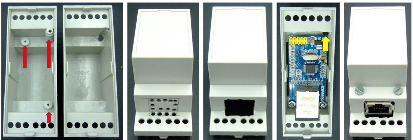
Mit 6mm-Bohrer diese Sockel entfernen
