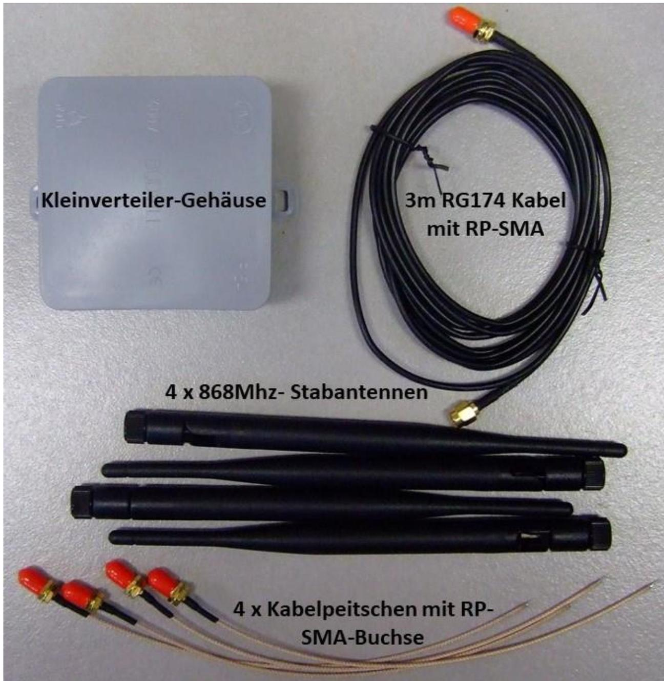
Das 3m RG174 Verlängerungskabel wird zuerst konfektioniert :
