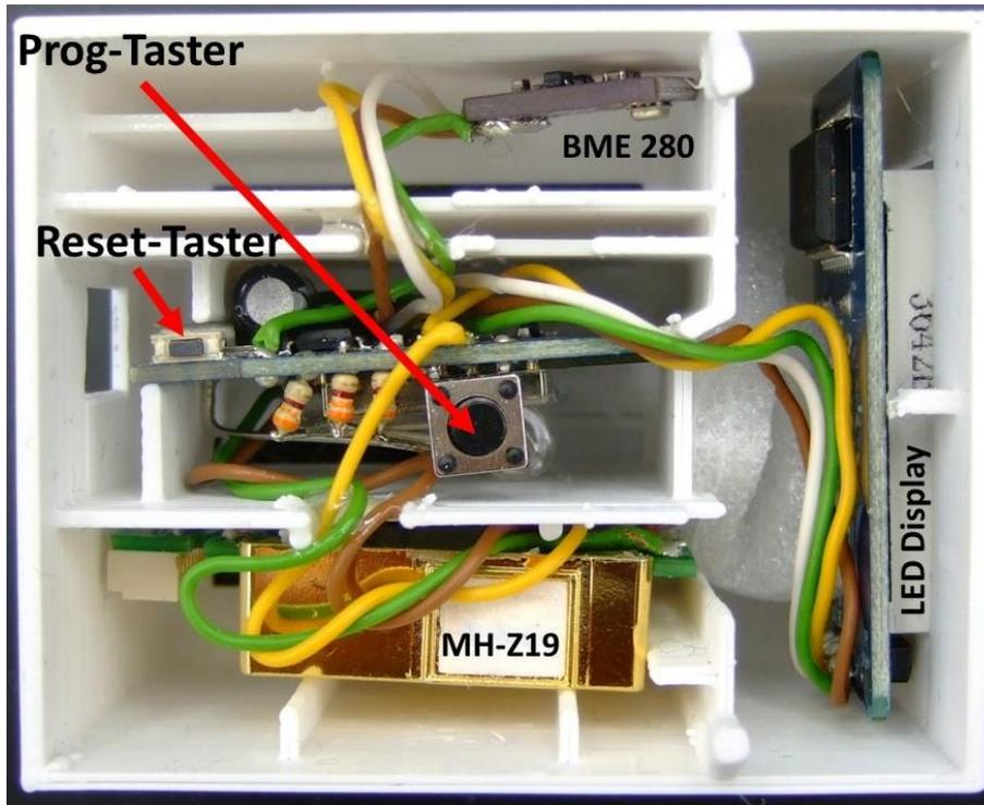
Wenn alles erprobt ist und funktioniert, dann wird das Display mit etwas Schaumstoff von hinten in die Aussparung gedruckt. Die Verbindungslitzen konnen mit etwas Kleber (ich verwende UV-hartbaren Schnellkleber) an den Ubergangen der Facher fixiert werden.
