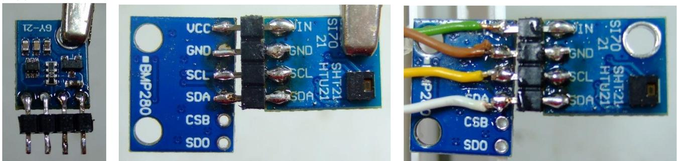
Abschließend das Geratchen unter der Lupe genau untersuchen, ob keine Lotspritzer oder Kurzschlusse vorhanden sind. Auch die Beinchen der RGB-LED mussen ausreichende Abstande haben, damit kein Kontakt beim Gehauseeinbau entsteht. Man kann ggf. mit etwas(!) Heikleber die blanken Drahntchen fixieren.
