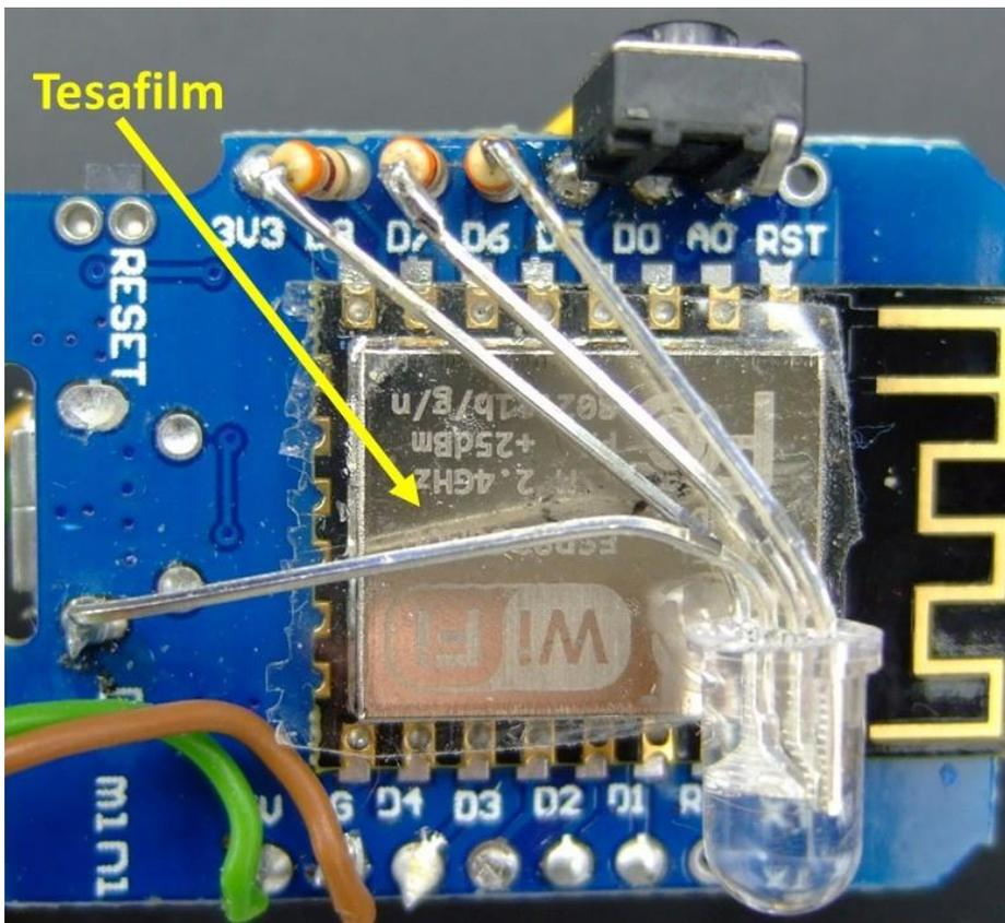
Das mitgelieferte Kabelstück wird nun abisoliert und wie im Bild unten gezeigt konfektioniert. Mit diesen flexiblen Litzen werden nun die verschiedenen Sensormodule und das LED-Display angelötet. Genau die vorgegebenen Kabelfarben verwenden!
