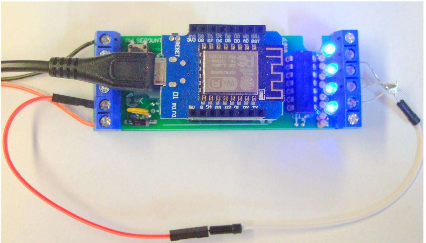
Der Impulsgenerator wird mit der richtigen Einstellung des param 2 aktiviert. Mit den standardmäßig eingestellten Parametern ist die Impulsfrequenz etwa 1Hz. Man sieht bei fehlerfreiem PULSECOUNTER dann alle vier LEDs im 1Hz-Takt blinken. Ist das nicht der Fall, dann ist irgendwo ein Fehler in der Hardware und man muß mit dem Digitalvoltmeter und dem Schaltplan auf Fehlersuche gehen. Die meisten Fehler sind Lötfehler, Bestückungsfehler und falsch eingesteckte ICs!
