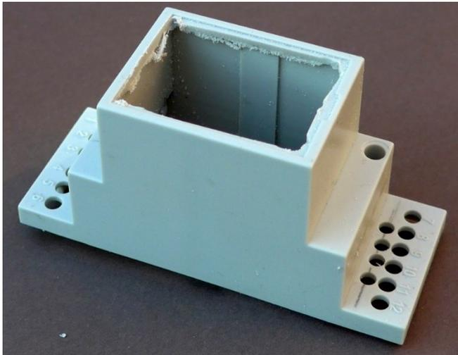
Die mitgelieferte Displayblende wird eingeklebt und das Ober und Unterteil des Hutschienengehäuses verschraubt.
