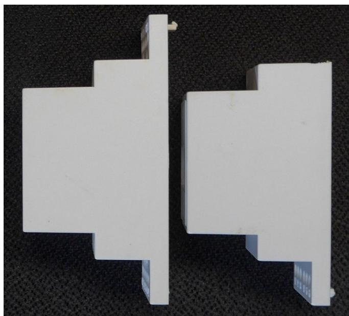
... und so sieht das aus. Hier das Oberteil mit der Displayblende für das optionale Display. Die Platine in der Bodenwanne sollte man mit seitlichen Unterlegteilen (Kabelstückchen etc.) in der Höhe so justieren, daß die seitlichen Kabellöcher auf Höhe der Schraubklemmen-Löcher ist.
