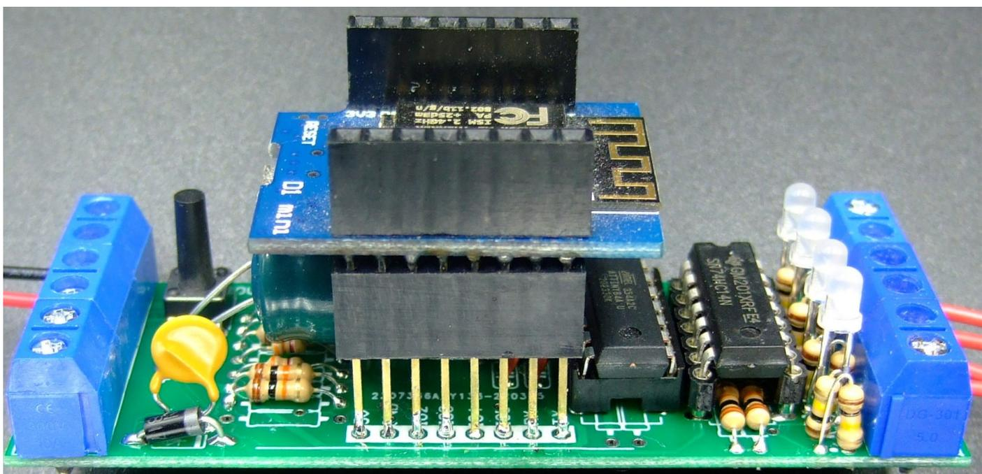
Bevor die Platine in das Hutschienengehäuse eingebaut wird, sollte man die grundsätzliche Funktion bereits auf dem Labortisch testen und ggf. auch schon die eigenen Router-Zugangsdaten eingeben. Dazu ist die 5V-Versorgungsspannung vom Netzteil anzulegen und **die erste Inbetriebnahme wie auf der Webseite beschrieben durchzuführen**. Wenn danach die eigene Webseite des PULSECOUNTERs mit einem Browser aufgerufen werden kann ist hier schon mal alles in Ordnung.
