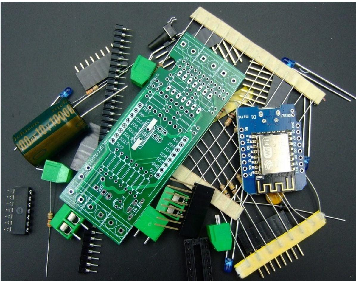
Ein möglichst temperatureregelter LötKolben (ca. 380°C) sollte für die Lötarbeiten vorhanden sein. Jetzt kann die Platine bestückt werden.
