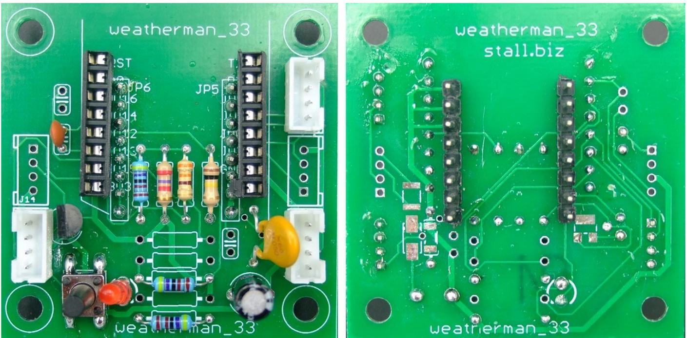
Über die beiden 8poligen Stiftleisten wird die Regenmelderplatine kontaktiert. Die Funktion ist mit folgendem Schemabild ersichtlich:
