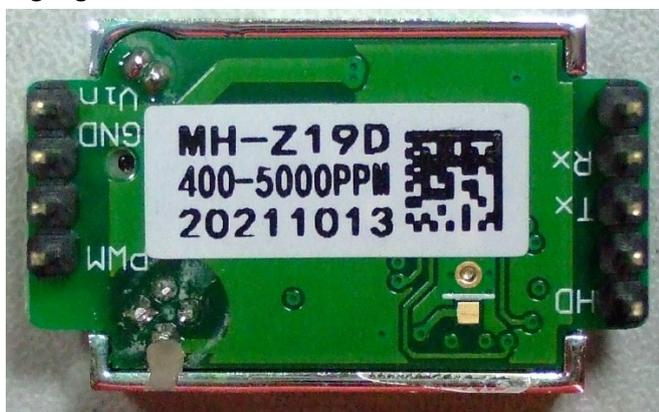
Bei diesem Sensor MH-Z19D oder MH-Z19E (silbernes Gehäuse) müssen vor der Verwendung die beiden Stiftleisten entfernt werden. Das kann entweder durch Auslöten oder vorsichtigem Abschneiden der Stifte mit einem scharfen Elektronik-Seitenschneider erfolgen. Angeschlossen wird das Grove-Anschlußkabel mit der roten Leitung an „Vin“, mit der schwarzen Leitung an „GND“ und mit der gelben Leitung an Pin „PWM“.
