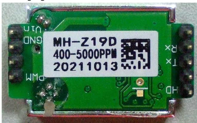
Bei diesem Sensor MH-Z19D (silbernes Gehäuse) müssen vor der Verwendung die beiden Stiftleisten entfernt werden. Das kann entweder durch Auslöten oder vorsichtigem Abschneiden der Stifte mit einem scharfen Elektronik-Seitenschneider erfolgen. Angeschlossen wird das Grove-Anschlußkabel mit der roten Leitung an „Vin“, mit der schwarzen Leitung an „GND“ und mit der gelben Leitung an Pin „PWM“.
