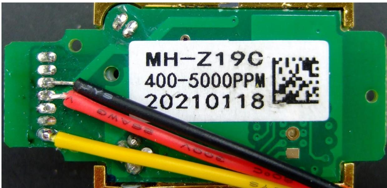
Das Anlöten ist etwas knifflig, weshalb man sicherheitshalber nach dem Löten mit dem Ohmmeter prüfen muß, ob nebeneinanderliegende Lötunkte auch wirklich keinen Kontakt haben.
