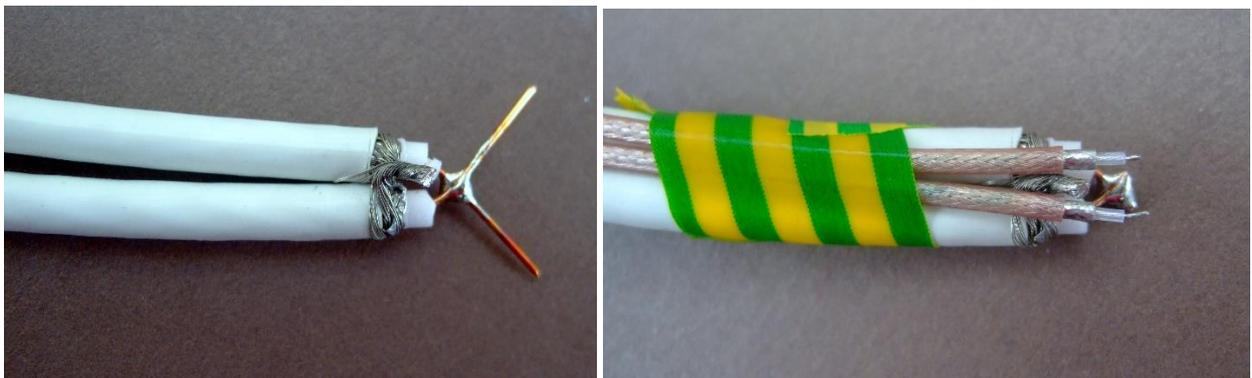
6. Jetzt an einer Seite des Doppel-Koaxkabels die beiden Kabelpeitschen mit den RP-SMA-Buchsen parallel anlöten. Dazu zuerst die Koaxkabel mit Isolierband genau fixieren, um dann einfach den Innenleiter und die Außenleiter zu verlöten.
