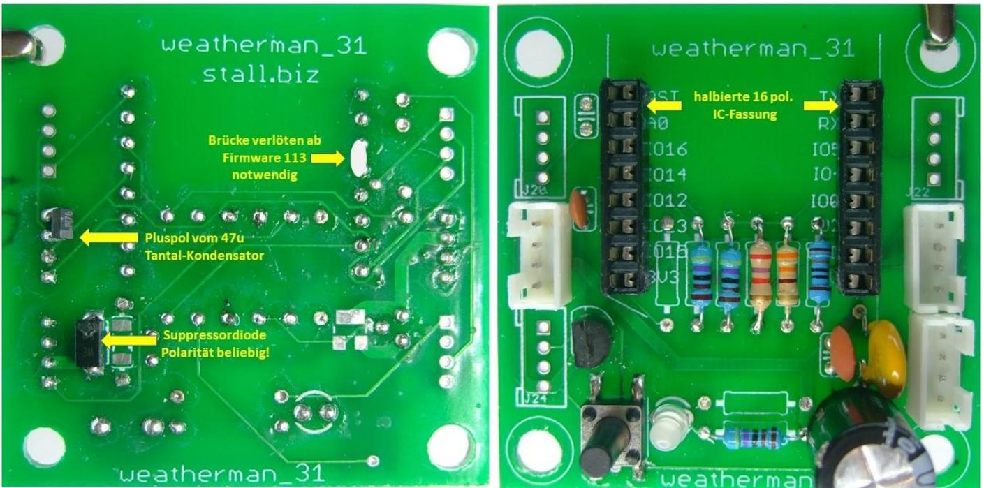
Der WeMos wird mit mehreren Steckbuchsen geliefert, die aber nicht alle benötigt werden. Man sollte diese Teile aufbewahren, weil sie u.U. für eine spätere Fehlersuche hilfreich sind. Die beiden Stiftbuchsen mit den langen Beinchen entsprechend den folgenden Bildern einlöten.
