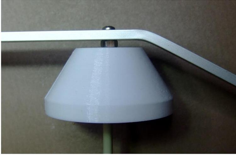
Man kann jedoch auch einfach die vorhandene Bohrung des Regenmengenmessers nutzen und anstatt der Gewindeschraube eine längere Blechschraube oder Universalschraube nutzen
