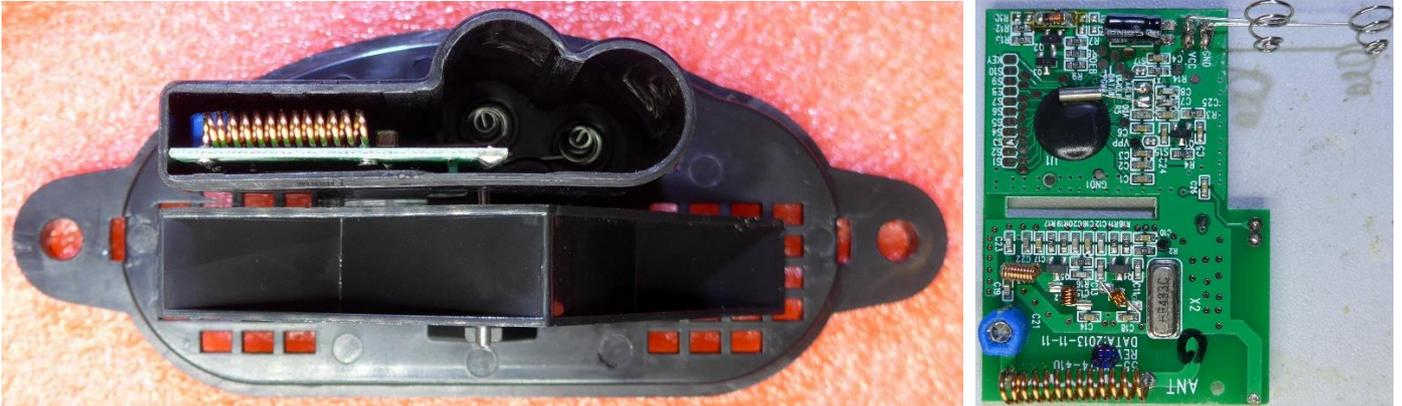
Will man nur den Regenmesser am Weatherman-Controller ( genauso wie den Regenmesser oben ) betreiben, dann wird einfach der Reedschalter vorsichtig ausgelötet und ein Stück seitlich versetzt, so dass nicht die Mittenstellung sondern die Endlage der Wippe detektiert wird. Die folgenden Bilder zeigen den Reedschalter im Original (linkes Bild) und rechts in der versetzten Position. Beim Auslöten des Reedschalters sehr vorsichtig vorgehen, damit das Glasgehäuse nicht beschädigt wird.
