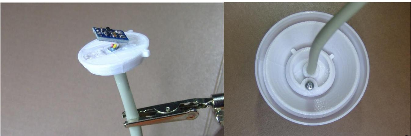
Montiert wird die Wetterkappe am Tragarm möglichst im Schatten des Controllergehäuses. Bei der Montage nicht die Distanzmutter vergessen, damit die Wärmekopplung zum Tragarm möglichst gering ist und die Entlüftung nach oben funktioniert. Ich habe die Wetterkappe am Übergang zum Regenmengenmesser montiert, siehe nachfolgendes Bild:
