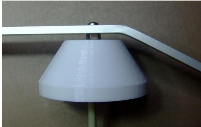
... und ganz wichtig: Kontrollieren, daß die Blechschraube nicht zu weit in den Sensorraum ragt, da sonst u.U. der Sensor beschädigt wird. Ggf. Blechschraube kürzen!
