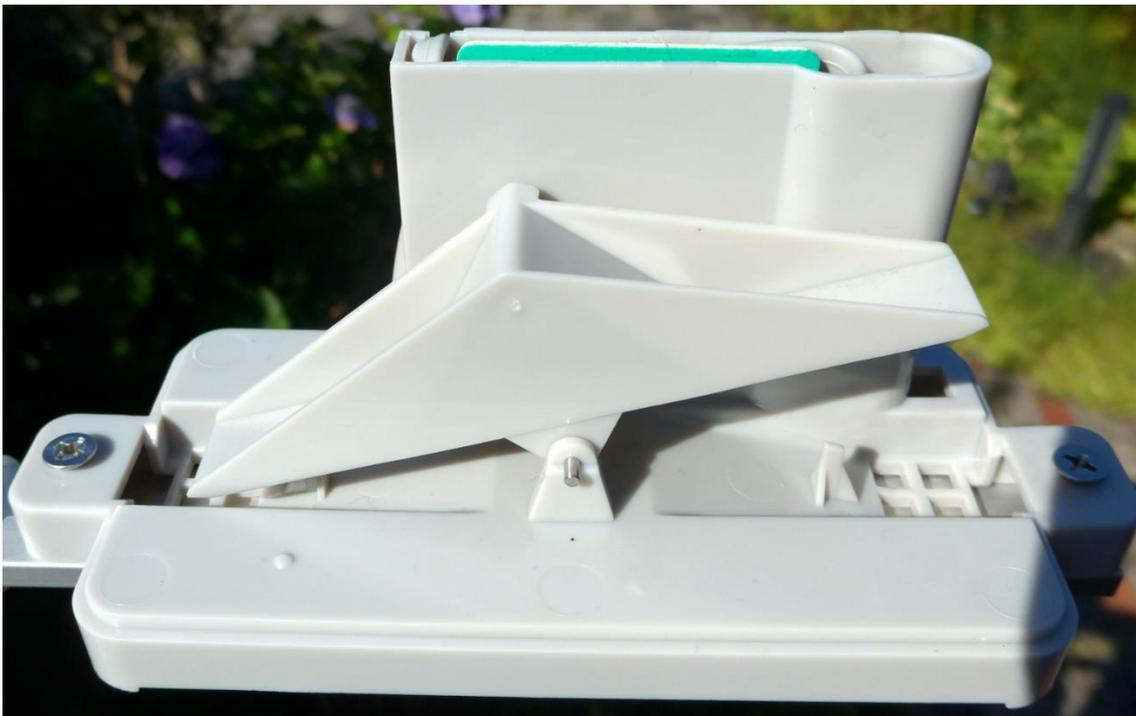
Sicherheitshalber mit dem Ohmmeter am Anschlusskabel prüfen, ob der Reedschalter in der einen Wippenposition EIN ist und in der anderen AUS. Dann ist schon alles erfolgreich geändert und Deckel wieder drauf!
