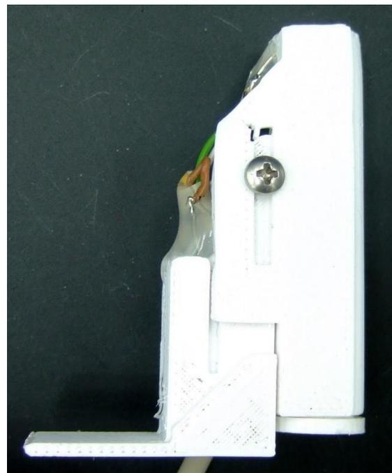
Abgangig vom verwendeten Wasserzahler und von der Brennweite der Linse wird der Tubus mehr oder weniger hoch- bzw. runtergeschoben, um einen moglichst kleinen grunen Leuchtpunkt auf dem Zifferblatt des Wasserzahlers zu erzeugen. Bei den meisten Wasserzahlern liegt dazu der Tubus komplett auf dem Zahlerglas auf, aber das mu man selbst optimieren.
