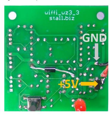
Die rote Plus-Leitung (+5V)wird an die 3 oberen Anschlusspunkte der Versorgungsspannungsbuchse (nicht eingebaut) angelötet. Das untere Lötauge bleibt frei. Die Masse (GND) an den im Bild sichtbaren Lötpunkt anlöten.
