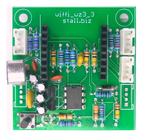
Bevor die Platinen-Unterseite mit einigen Bauteilen bestückt wird, sollte mit einem Elektronik-Seitenschneider die Beinchen der Bauteile kurzmöglich abgeschnitten werden und danach alle Lötpunkte überlötet werden. Dadurch wird der Lötkontakt deutlich zuverlässiger.
