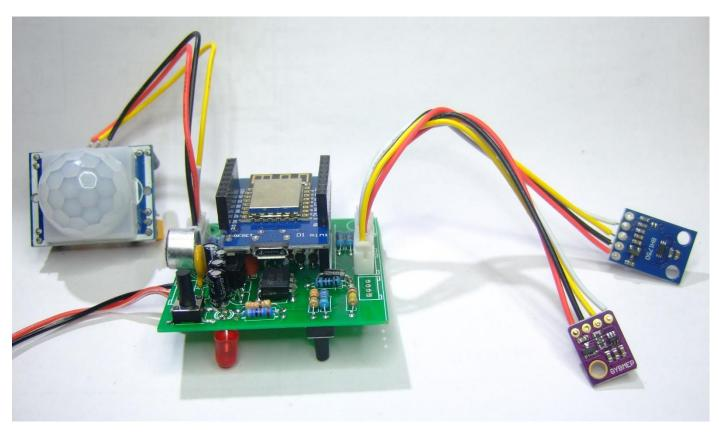
Jetzt alle Sensormodule anstecken und Versorgungsspannung wieder einschalten. Nach einem 5sec Dauerleuchten der roten und blauen LED am Anfang versucht der WIFFI (erfolglos!) sich in das heimische WLAN einzuloggen, was mit Blinken der roten LED signalisiert wird. Deshalb müssen erst mal die WLAN-Router Zugangsdaten im sog. Hotspot-Modus des WIFFI einprogrammiert werden. Mehr dazu auf der <u>Webseite des WIFFI 3.0</u>.
