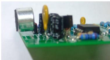
Dann das Mikrofon wie im Bild rechts einlöten. Jetzt alle restliche Bauteile auf der Platinenoberseite entsprechend dem Bestückungsplan verlöten. Die folgenden Bilder zeigen das Ergebnis.
