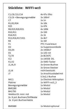
Das obere Bild zeigt die Stückliste mit den Bauteilen und deren Lage auf der Controller-Platine.
