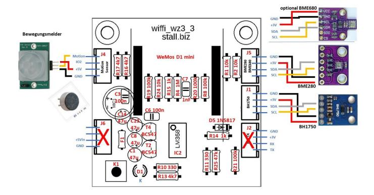
Die wesentlichen Funktionsteile sind das Mikrofon für den Geräuschmelder, der Bewegungsmelder auf Infrarotbasis, der Helligkeitssensor BH1750 und standardmäßig der BME280 für Luftdruck, Temperatur und Feuchte. Alternativ zum BME280 kann ein BME680 verwendet werden, der zusätzlich zu den vorgenannten Meßgrößen noch die Luftqualität messen kann.
