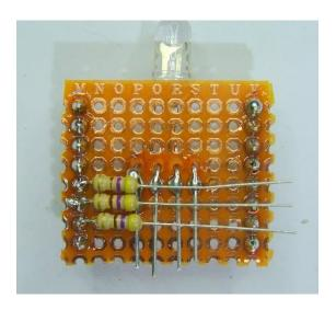
4 Wie auf dem Bild Widerstände anlöten und Masseleitung einfügen. Modul auf WeMos aufstecken und vorher LED etwas nach unten biegen.
