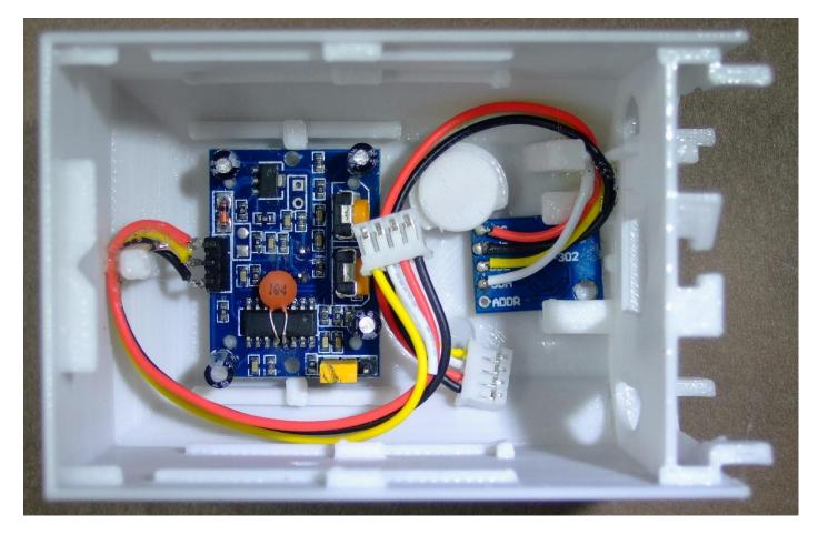
Zuersrt den Bewegungsmelder einklipsen und das Kabel mit etwas Kleber am Pfosten wie im Bild fixieren. Den Helligkeitssensor rechts im Bild bei herausgezogenem Tasterstempel (oben) in die Führung einschieben und das Kabel ebenfalls am Pfosten mit etwas (!) Kleber fixieren.
