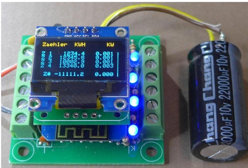
Das Display wird auf die obere Buchsenleiste des WeMos aufgesteckt. Beim Aufstecken genau die Orientierung des Displays beachten. Dazu das obige Bild genau ansehen!
