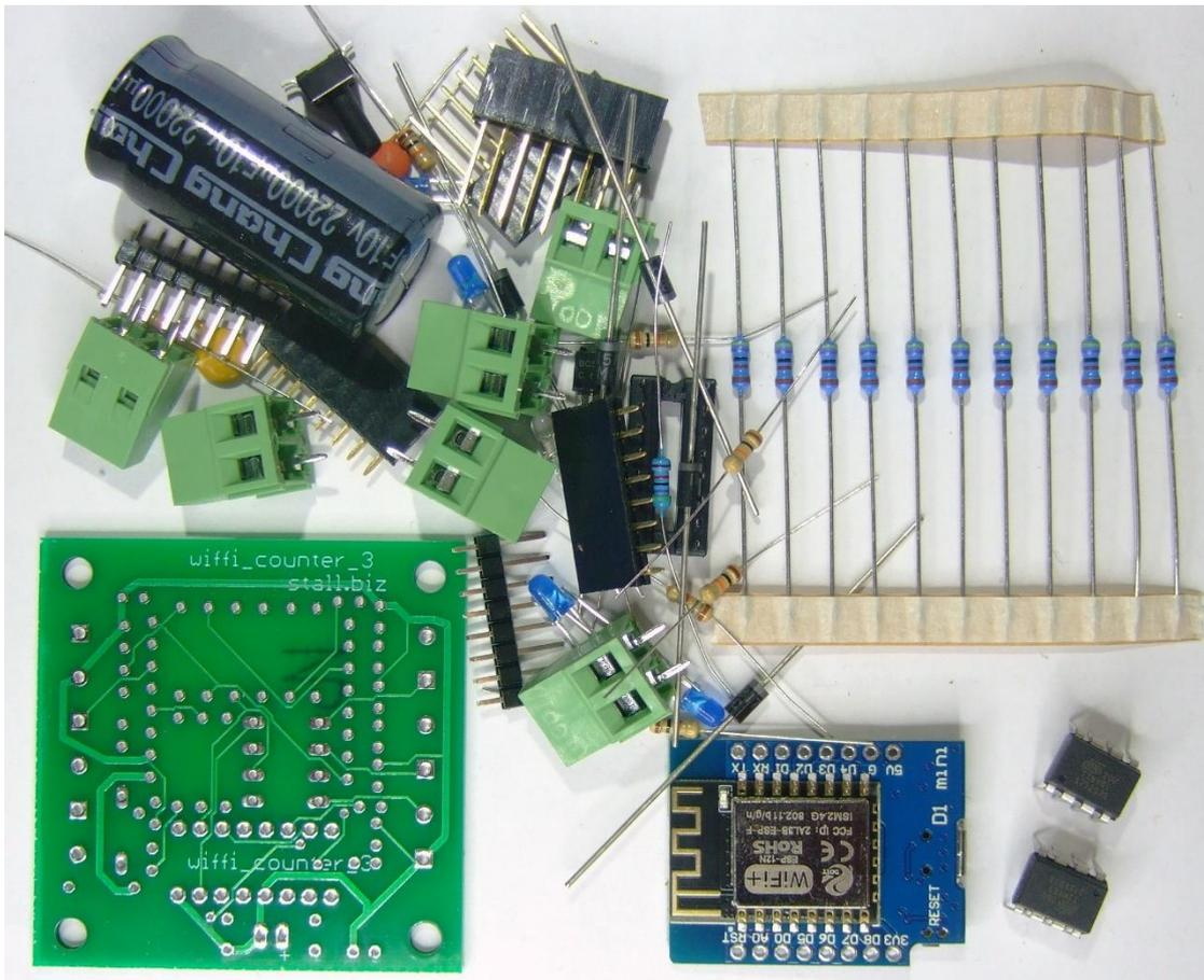
Seit 01/2020 wird im Bausatz noch eine zweite 16pol DIP-Fassung mitgeliefert. Damit kann man (muß man aber nicht!) eine verbesserte alternative Fassung für den WeMos erzeugen. Die standardmäßig beim WeMos verwendete Fassung sind zwei 16pol Buchsenleisten, die aus einer normalen 16pol DIP-Fassung, wie auf dem folgenden Bild gezeigt, hergestellt wird.
